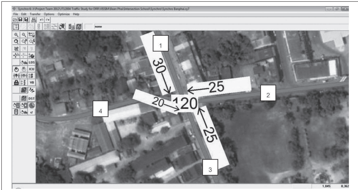
รูปที่ M5a-8 แสดงรอบสัญญาณไฟจากการ Optimize จาก Synchro
