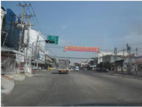
รูปที่ M4a-1 เส้นจราจรไม่ชัดเจน
