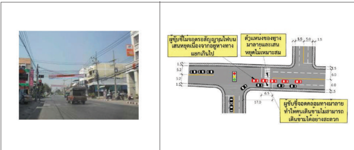
รูปที่ Pc4 - 2 ตำแหน่งของทางม้าลายไม่เหมาะสม
